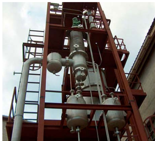
La tecnología de Zean permite la destilación a alto vacío.
