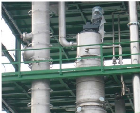
Detalle del destilador en continuo o apurador final
